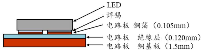
图 4 电路板安装时结构
