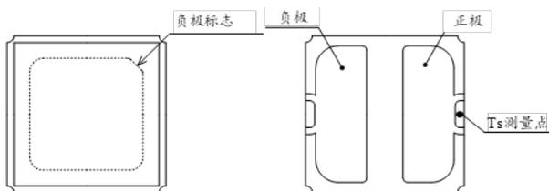
图2  $T_S$  测量点 (NVSU233B)
