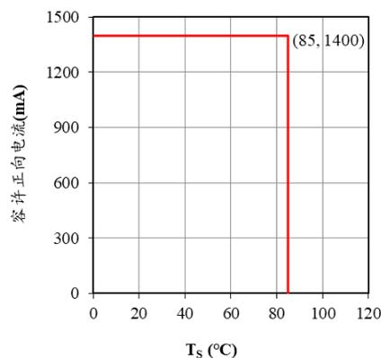
图1 “ $T_S$  vs. 容许正向电流”特性
