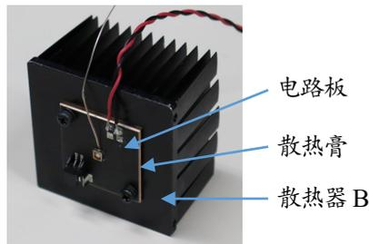
照片 4 评价光源的散热结构 (NVSU233B)
