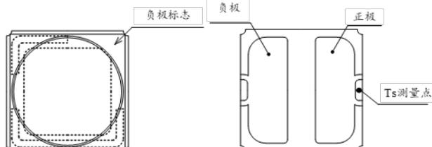
图3  $T_S$  测量点 (NVSU233B-D4)
