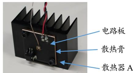
照片 3 评价光源的散热结构 (NVSU233B)
